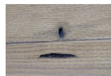
Leere Harzgallen und kleinere Ausfalläste
