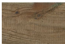
Rauhe Stellen auf der Holzoberfläche
